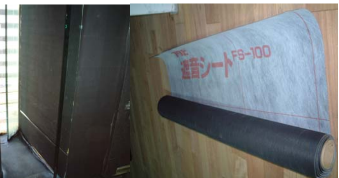
圖 14 以制振貼片改善玻璃帷幕表面振動量
